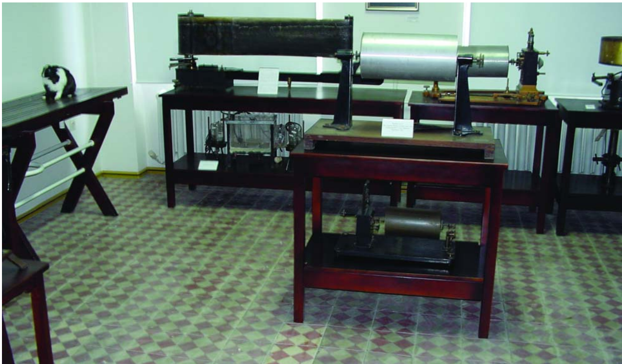
Hayvan deneylerinde kullanılan aletler (Kimograf) ve traseler
