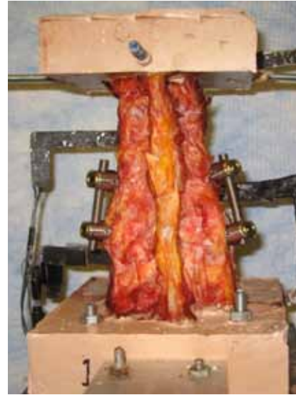
Şekil 2: İmplant Testi İçin Hazırlanan Taze İnsan Omurga Kadavrası Test Düzeneği
